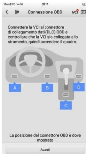
**Figura 8-5 Schermo di connessione OBD**
