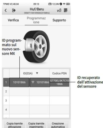
**Figura 6-5** Schermata di programmazione tramite codice componente OEM.
