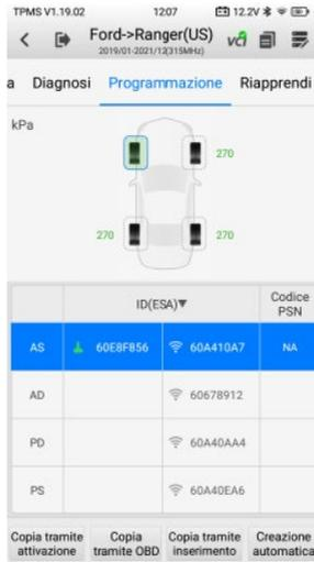
**Figura 5-21 Schermata Copia tramite attivazione completata**
