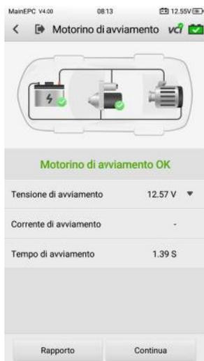
**Figura 8-11 Schermata dei risultati del test di avviamento**
