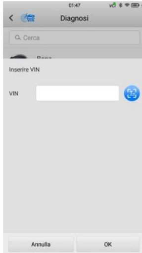
**Figura 7-6 Inserimento manuale del VIN**
