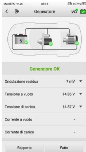
**Figura 8-13 Esempio di schermata di prova fuori dal veicolo**
