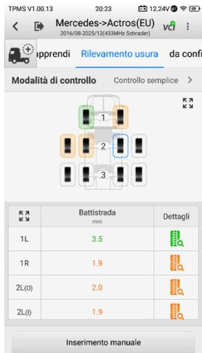
**Figura 4-30 Schermo di controllo del battistrada singolo**
