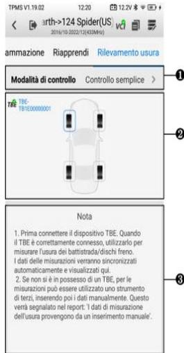
**Figura 5-33 Schermo di rilevamento dell'usura**
