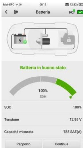
**Figura 8-8 Schermata dei risultati della batteria**
