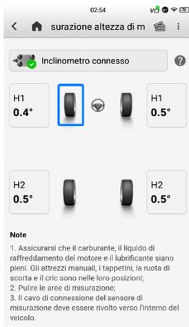
**Figura 11-3 Schermata dei risultati della misurazione dell'altezza di marcia**
