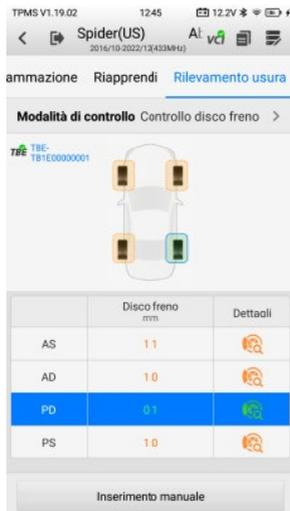
**Figura 5-38 Schermo di controllo del disco freno**
