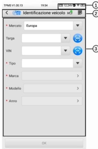
**Figura 4-2 Schermata di identificazione del veicolo**
