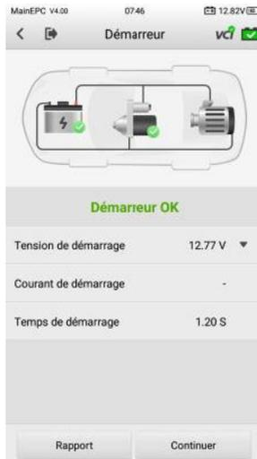
**Figure 8-11 Écran de résultat du test de démarrage**
