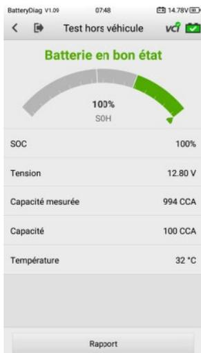
**Figure 8-14 Écran de résultat du test hors véhicule**
