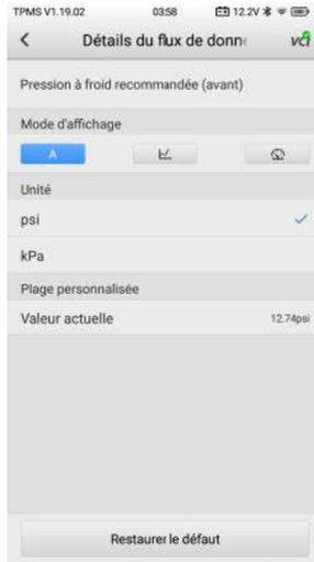
**Figure 5-16 Détails de l'écran de données en direct**
