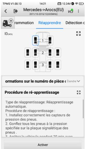
Figure 4-23 Écran de réapprentissage automatique 1
