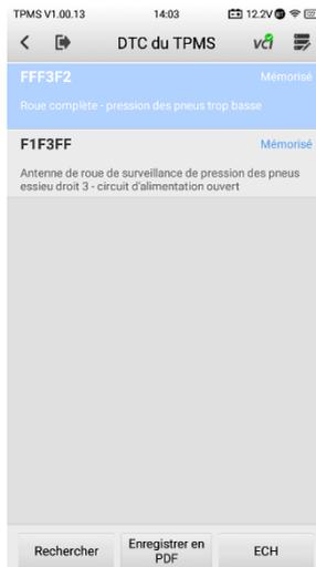
Figure 4-13 Écran CV TPMS DTC
