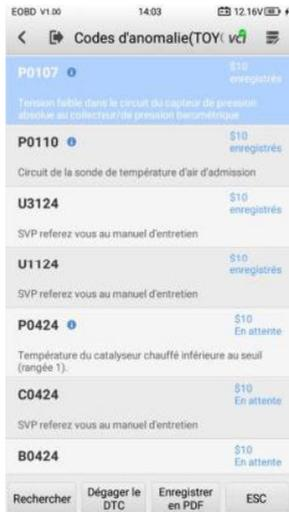
Figure 7-15 Écran DTC et FFD
