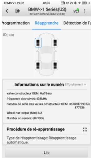
Figure 5-27 Écran de réapprentissage automatique 1
