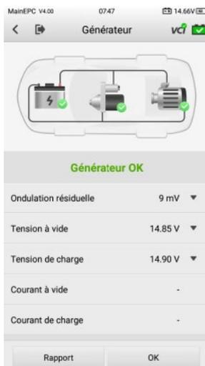
Figure 8-12 Écran de résultat du test du générateur
